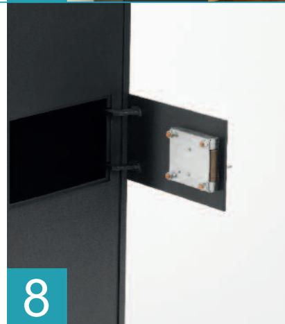
8 Per eventuale sostituzione della serratura, svitare i 4 dadi, sfilare la serratura, da sostituire, posizionare la nuova serratura, inserire la chiave nella toppa, serrare nuovamente i 4 dadi.
