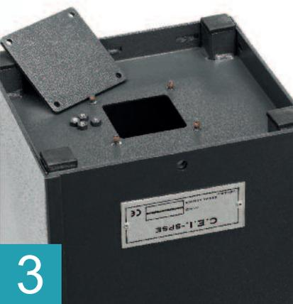
3 Prima di posizionare il Bussolotto, capovolgerlo, rimuovere la piastra, riempire con la sabbia di contrappeso, ricollocare la piastra di tenuta. Posizionare il Bussolotto nel sito prescelto.
